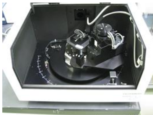
自動絶対反射率測定装置内部画像 〔試料(眼鏡レンズ)セット状態〕
